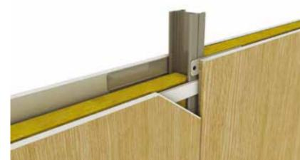
Collage et prise en feuillure de la languette acier sur l'autre bord de la plaque de plâtre à chants rebordés.
